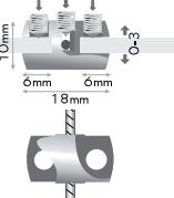
**IT** pinza laterale doppia, morsetto laterale per il fissaggio su cavi di due pannelli affiancati. il fissaggio di pannello e di cavo avviene tramite le brugole. spessore del cavo: max. Ø1,2mm.
