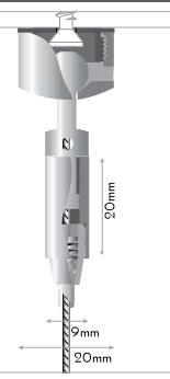
**IT** tirante snodabile per cavi, sistema variabile, montare il tirante ed inserire il cavo: il sistema di autobloccaggio lo trattiene automaticamente, la tensione del cavo si regola avvitando la parte snodabile del tirante, spessore del cavo: max. Ø1,2mm.
