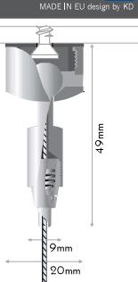
**IT** tirante snodabile per cavi, sistema autobloccante. fissaggio a soffitto universale per cavi di acciaio o nylon. montare il tirante a soffitto e inserire il cavo nel morsetto. il meccanismo di autobloccaggio trattiene automaticamente il cavo max. Ø1,2mm.
