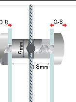
**IT** connettore bifacciale per pannelli, sistema a brugola. per la connessione laterale di due pannelli su cavi di acciaio. il fissaggio di pannello e cavo avviene tramite brugole. spessore del cavo: max. Ø1,2mm
